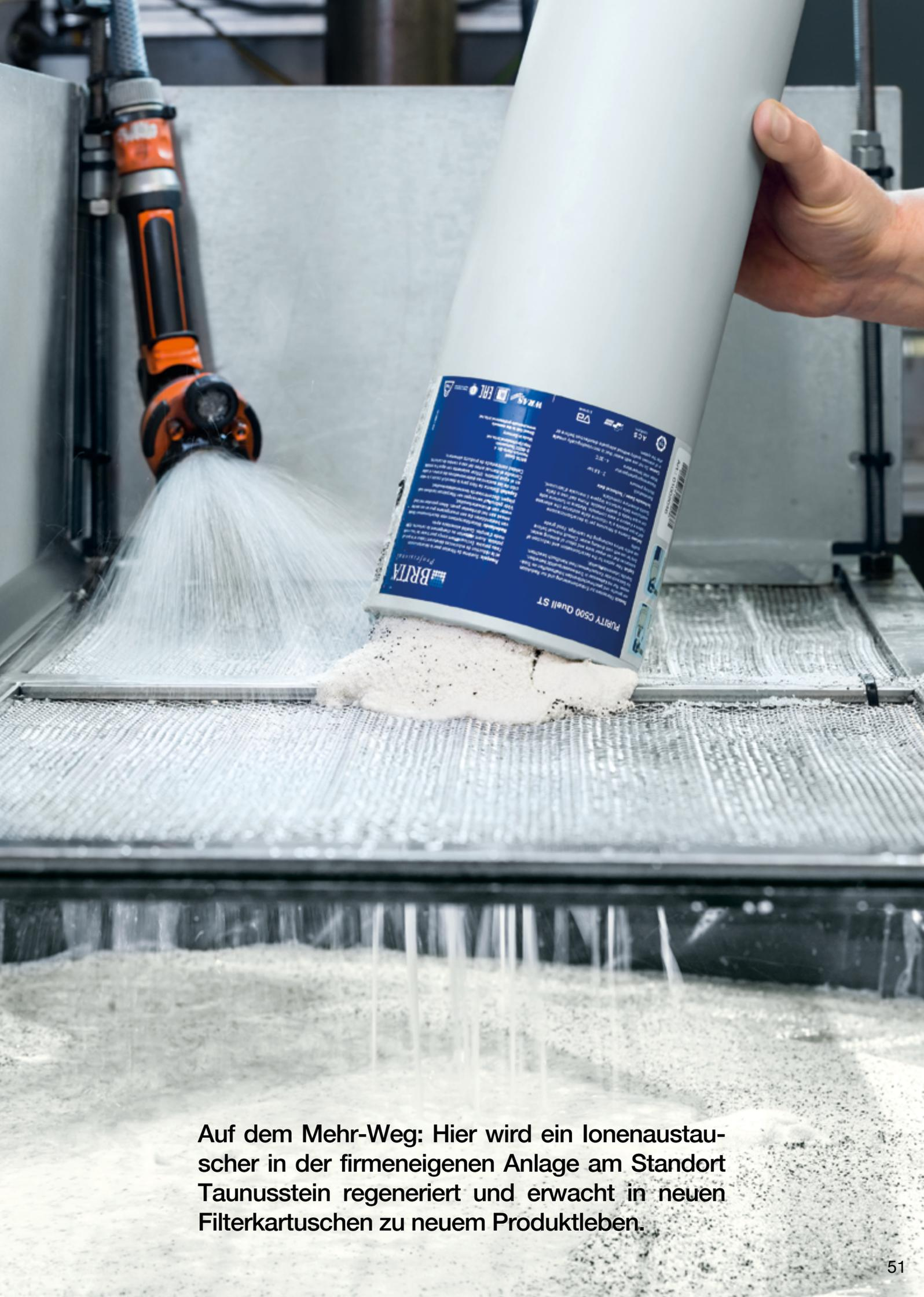
**Auf dem Mehr-Weg: Hier wird ein Ionenaustauscher in der firmeneigenen Anlage am Standort Taunusstein regeneriert und erwacht in neuen Filterkartuschen zu neuem Produktleben.**
